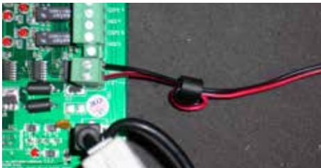
Ferrithülse auf dem Stromversorgungskabel
